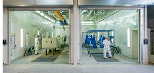
Die Lackierung und Trocknung der Bleche gehören zu den energieintensiven Prozessen der AMF-Bruns GmbH & Co. KG.
